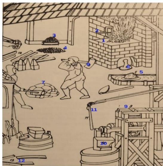
1 tavicí pec, 2 ovládání měchů, 3 dřevěné uhlí, 4 ruda, 5 vápno, 6 odtok strusky, 7 lupa, 8 dřevěná palice, 9 vodní kladivo hamr, 10 kovadlina, 11 ovládání přítoku vody na vodní kolo, 12 šíny
